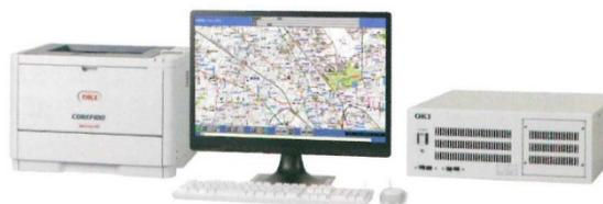
地図付きの出動指令書を発行する装置です。出動準備室及び各消防支署に設置します。本署出動準備室は地図や支援情報を全員が確認できるよう、大型ディスプレイを設置します。
