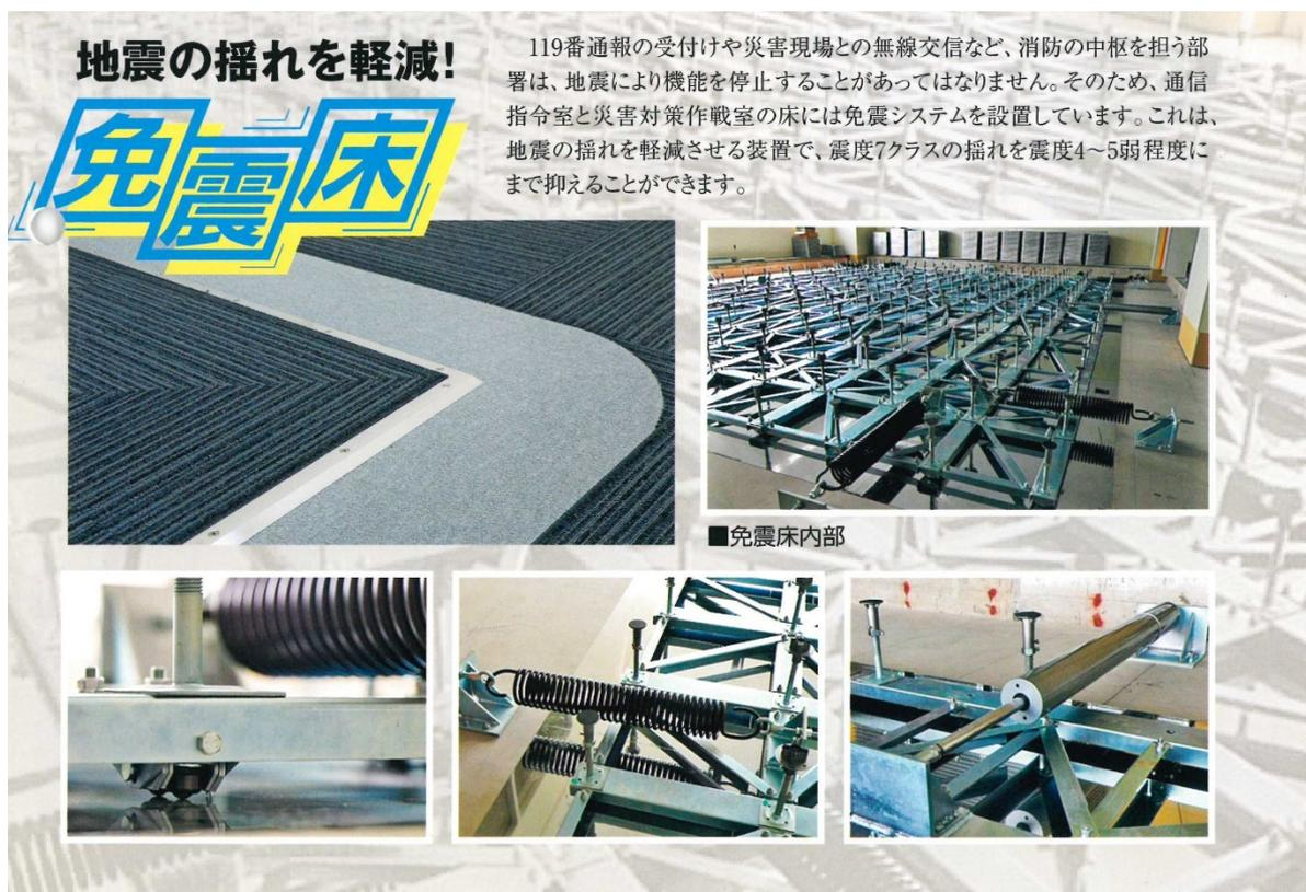
地震が発生した際に、建物自体に損傷がない場合でも、建物内部の機器や備品などが転倒・損壊する被害に見舞われることがあります。特にコンピュータールームなど重要なフロアでの被害を未然に防ぎ、機能を維持するための対策が必要となってきます。そこで、地震から守りたいフロアだけに免震を施すことができるのが「免震床」です。「免震床」上における水平方向の加速度は、設置床の10分の1程度に低減され、震度7が震度5弱程度に、震度5が震度3程度に揺れが小さくなります。
